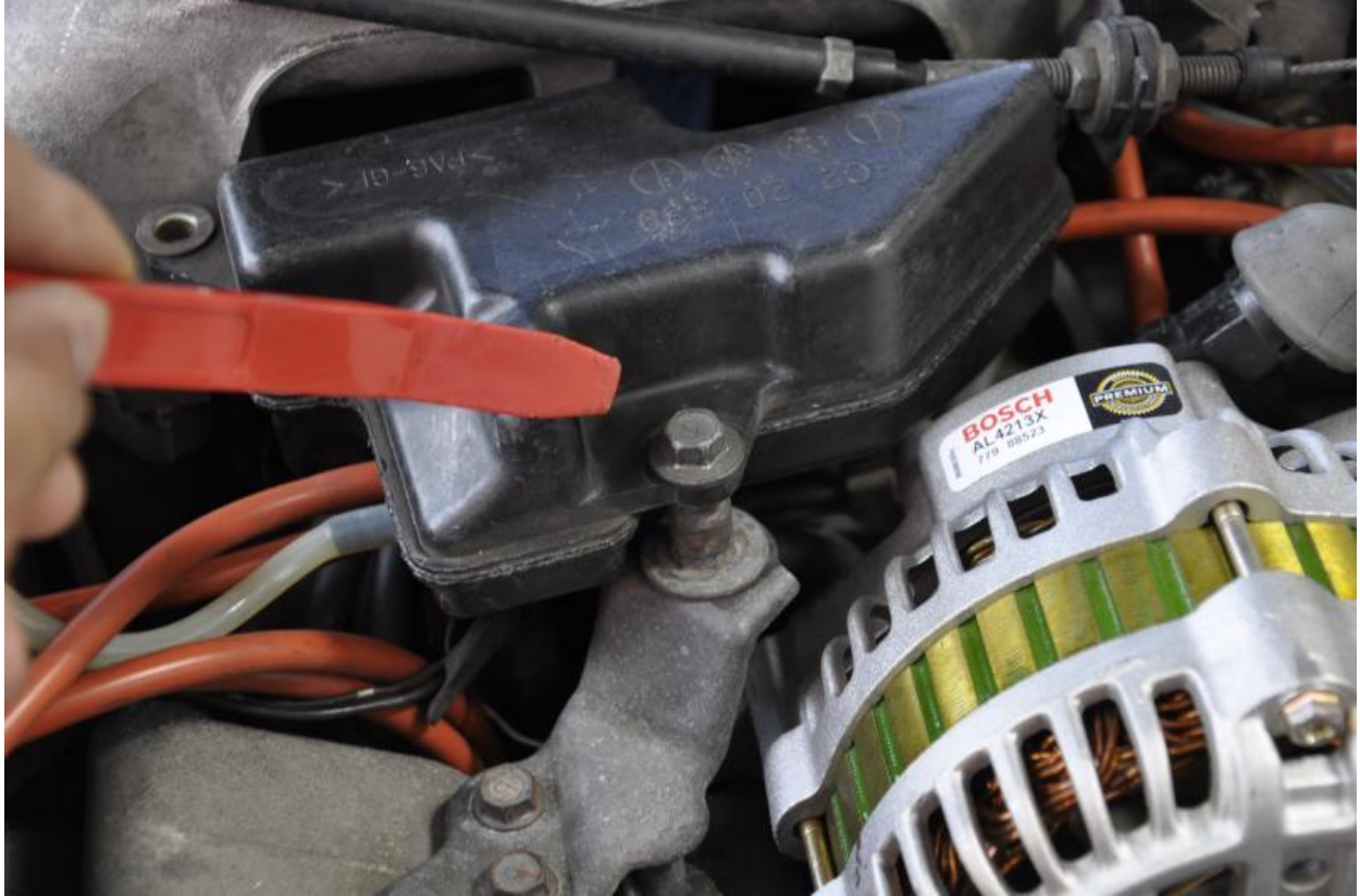
Remove this 10mm bolt.
